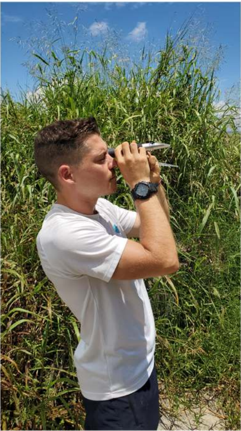
Figure 10. Mesure de la salinité de l'eau.
